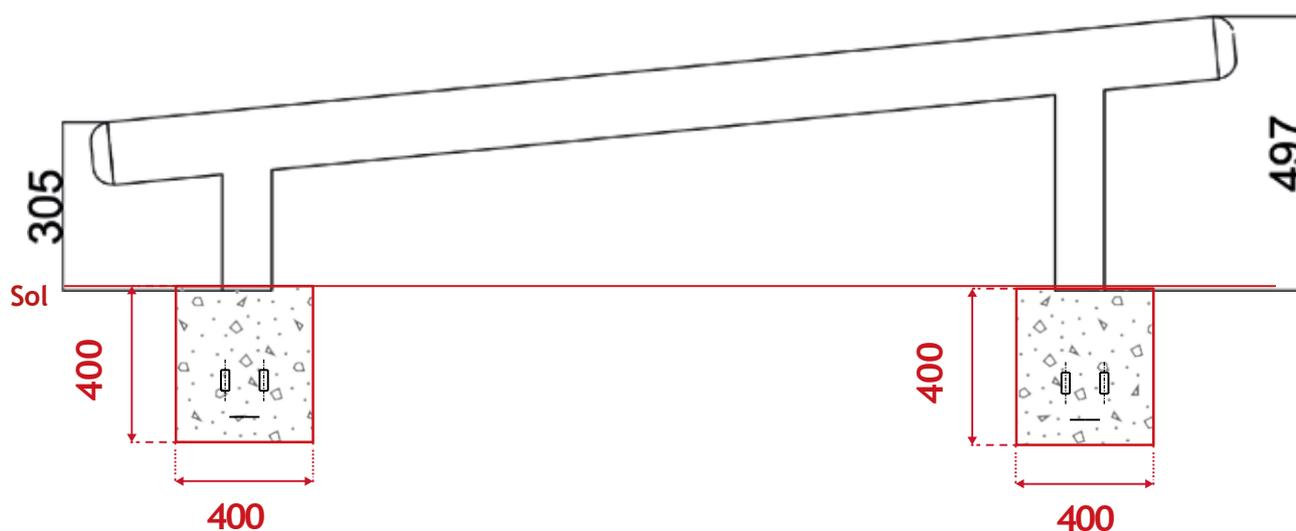
Annegare i gambe dell'attrezzo direttamente nei blocchi di cemento di 400x400x400 mm. Controllare direttamente l'interasse del modello.
