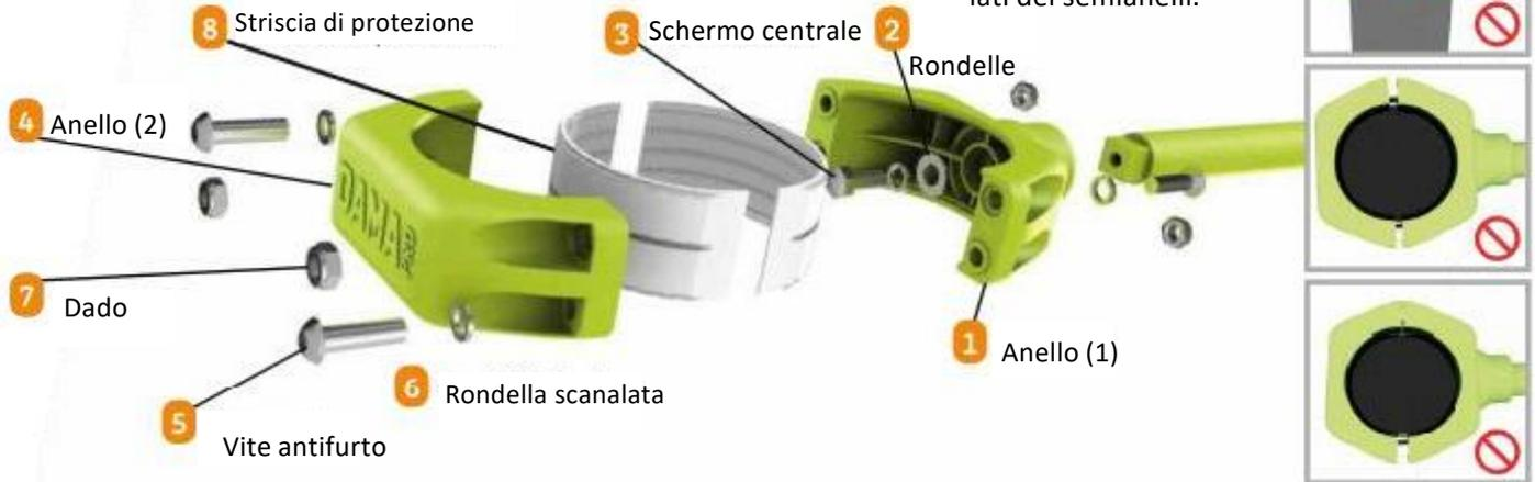
Prendere la barra per adattarla al primo anello **1**, inserire la rondella **2** e serrare con il dado centrale **3**. Prendere la seconda parte dell'anello **4** e fissarla alla prima con le viti antifurto **5**, le rondelle scanalate **6** e i dadi **7** ( non dimenticare di mettere le strisce protettive **8** all'interno degli anelli).
