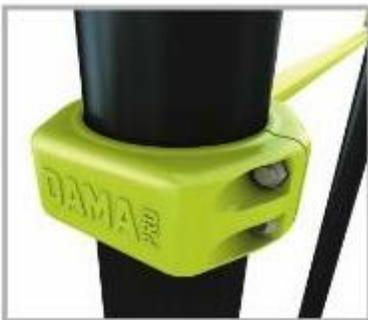
Per il fissaggio degli anelli sui montanti, si monta metà dell'anello (barra laterale), quindi si chiude sul palo entro la seconda metà. Assicurarsi di serrare gradualmente le viti in modo che gli anelli siano ben fissati. Montare la struttura progressivamente nei fori della fondazione. Tenere la struttura con i montanti in modo che sia a livello e non si muova durante l'asciugatura. Una volta che il calcestruzzo viene versato nelle buche, isolare l'area.
