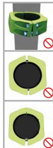
Prendete la prima parte dell'anello **1** e la seconda **2** fissarle tra di loro con le viti antifurto **5**, le rondelle scanalate **6** e i dadi **7** (non dimenticare di mettere le strisce protettive **8** all'interno degli anelli).
