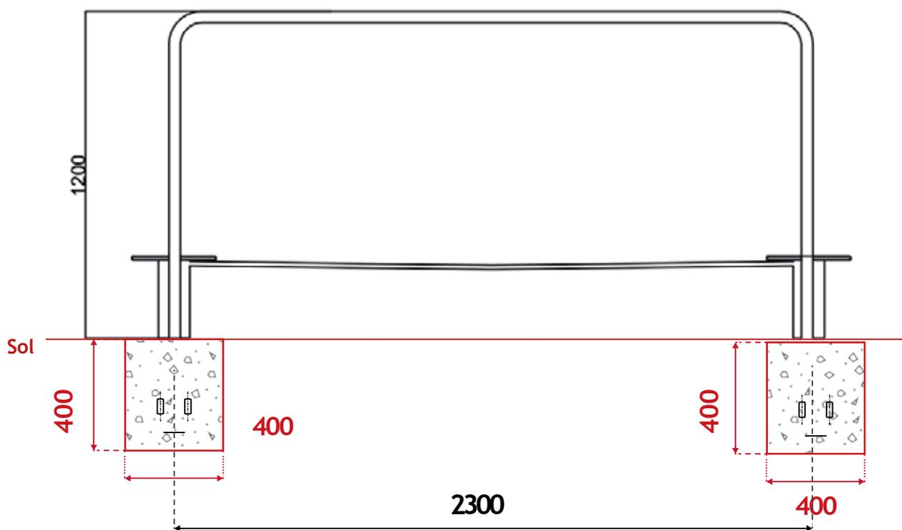
Annegare i gambe dell'attrezzo direttamente nei blocchi di cemento di 800x400x400 mm. Verificare l'interasse del modello.
